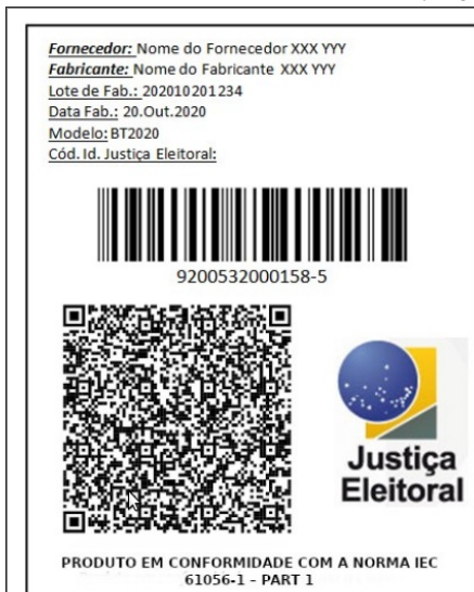
Figura 3 – Modelo de etiqueta da bateria
