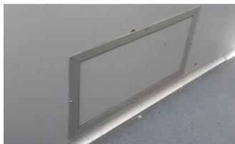
Local de acesso no interior do veículo após relocação da bateria.
