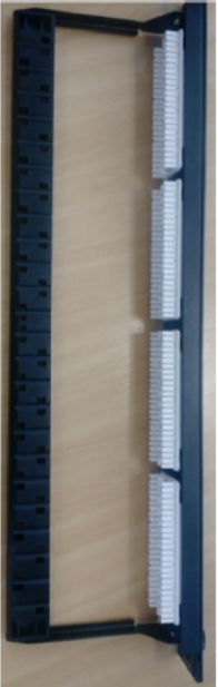
FOTO 02 - Montagem da Guia Traseira
